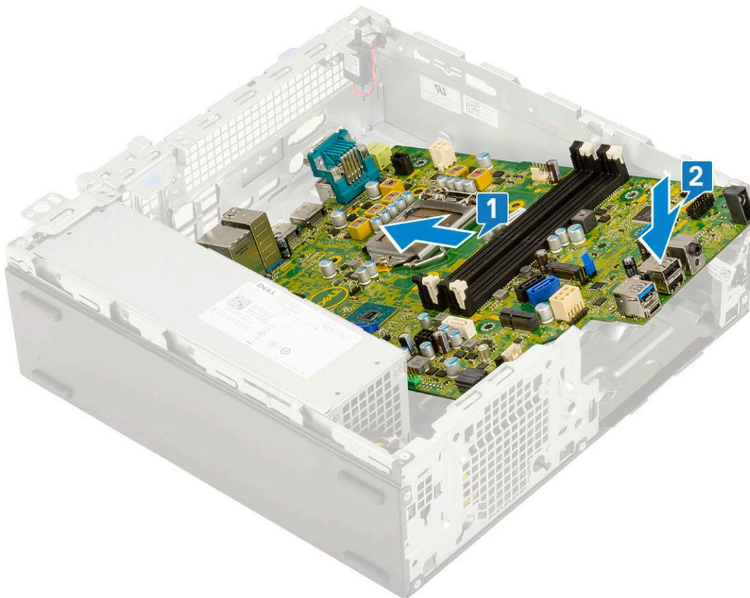
3. Bringen Sie die einzelne Schraube, die als Montagepunkt für das M.2-SSD-Laufwerk verwendet wird, die einzelne Abstandsschraube (#6-32) und die 5 Schrauben wieder an, mit denen die Systemplatine am System befestigt ist [1, 2, 3].
