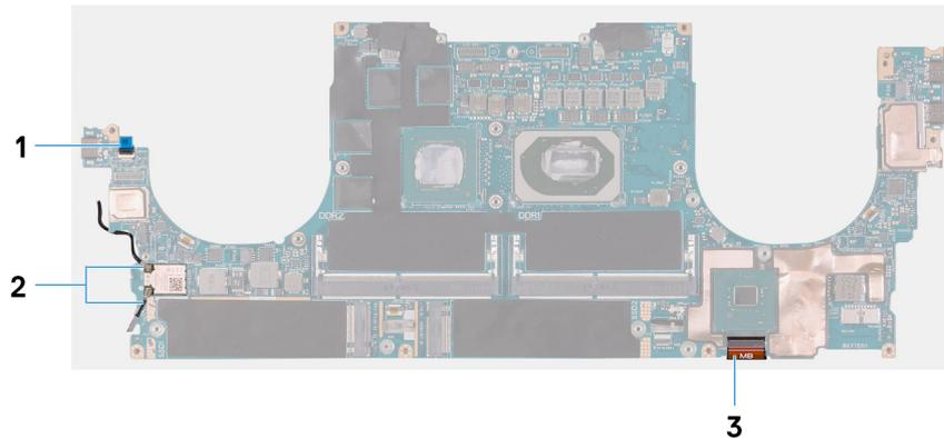
**Abbildung 2. Systemplattenanschlüsse**
