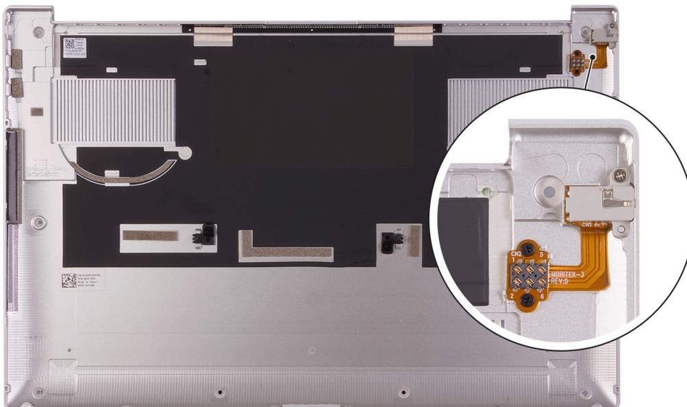
2. Hebeln Sie die Bodenabdeckung beginnend in der linken unteren Ecke mithilfe eines Kunststoffstifts in Pfeilrichtung auf, um die Bodenabdeckung aus der Handballenstützen- und Tastaturbaugruppe zu lösen.
